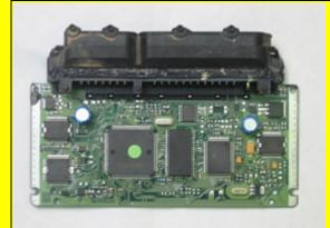
CENTRALINA DI GESTIONE MOTORE ME 7.5.10 INSTALLATA SULLE VETTURE DEL GRUPPO VAG BENZINA.
